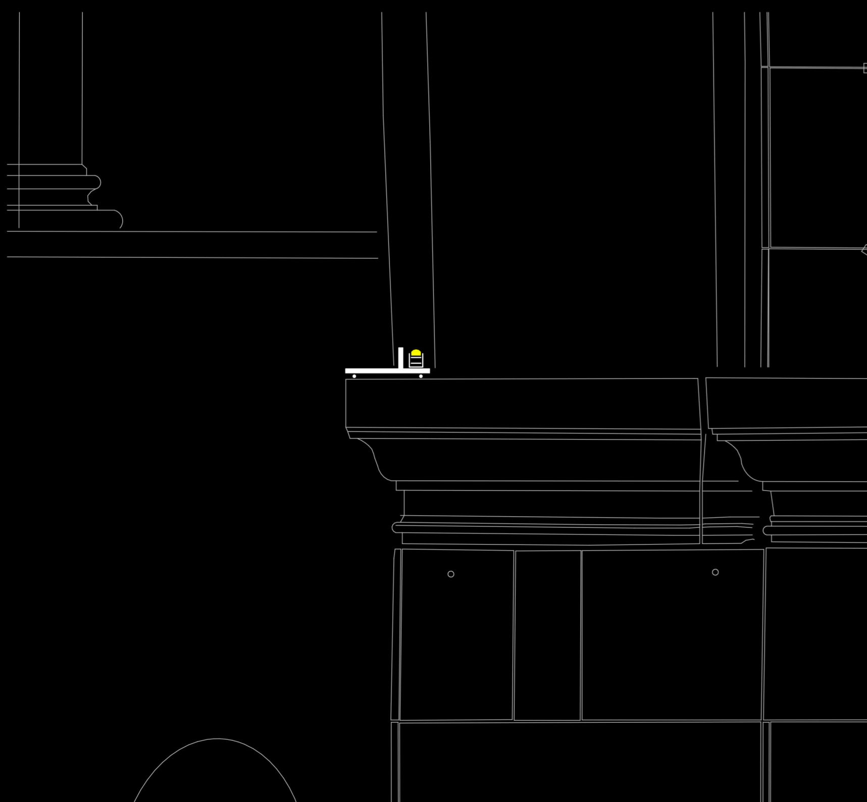
Detail Ausleuchtung_Lichtgesims Schnitt Umgang Oktogon_M 1:10
